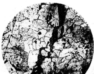
Рис. 3. Межкристаллитные трещины в околошовной зоне
